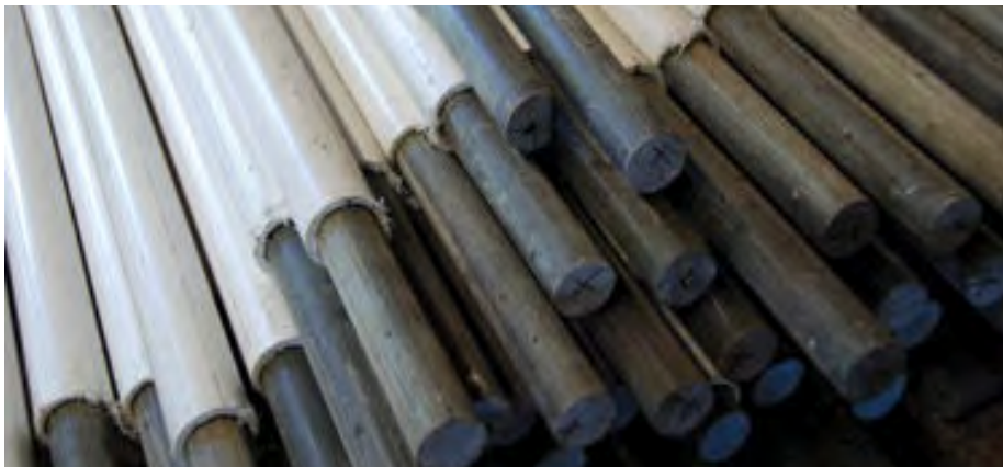
De fiberglasstokken schuiven in een kunststof buis en worden met een dop afgesloten. Het zorgt voorkomt dat de koeien in aanraking komen met de scherpe randen van de buizen.
